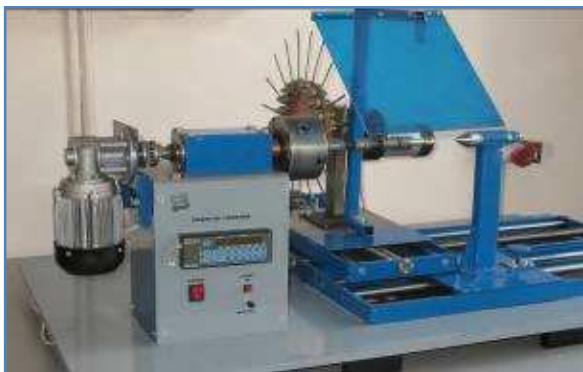
Imaginea instalației de recondiționare a pieselor de mașini de formă cilindrică
